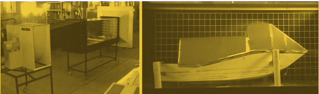
Fig.18. Túnel de viento (2008) diseñado y construido en convenio con la Escuela de Ingeniería Mecánica. La mayor resistencia del modelo al emerger sobre el agua en velocidad, es el aire. El túnel de viento permite medir esta resistencia, mediante un dinamómetro (Kg.), con distintas intensidades. Esto permite cualificar y cuantificar la forma aerodinámica del casco y de la superestructura sobre el agua.
