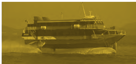
Fig.7. Turbo Jet de servicio, lo que acelera los pasajeros en todo el delta del río Perla entre Hong Kong y Macao, en menos de una hora, con una velocidad media de 45 nudos (83 km/h), utilizando principalmente Boeing's Jetfoil.
