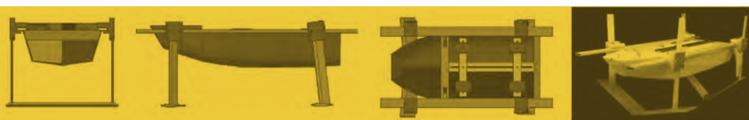
Fig.13. Modelo ajustable, mediante un sistema de coordenadas móviles de aluminio se va ajustando la posición de los perfiles en el casco, hasta lograr que éste emerja del agua. Las variables a ajustar son: 1. la distancia de los perfiles al casco; 2. La distancia entre ellos, perpendiculares al eje de la eslora; 3. Los ángulos de ataque del perfil de proa y de popa.
