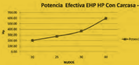
Fig.17. Programa de cálculo de potencia (2010) los datos del modelo (fuerza/velocidad) suministrados por el canal de pruebas, deben ser traspasados al prototipo, mediante las ecuaciones de similitud. Para la simplificación del cálculo se diseñó un programa Excel, que permite obtener la potencia del prototipo con seguridad y rapidez.
