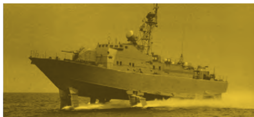
Fig.4. En la década de los 80 se construyó la patrulla rápida hidroplanos "Antares". El desplazamiento es 220t, la velocidad máxima es de 60 nudos, velocidad de crucero es de 50 nudos.
