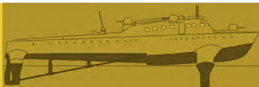
Fig.3. Alemania, 1938 Transport Hydrofoil VS8. Tenía la capacidad de transportar un tanque pequeño o mediano (Panzer 38T o IV), que se almacenaba en un pontón especial diseñado en la parte posterior de la nave.
