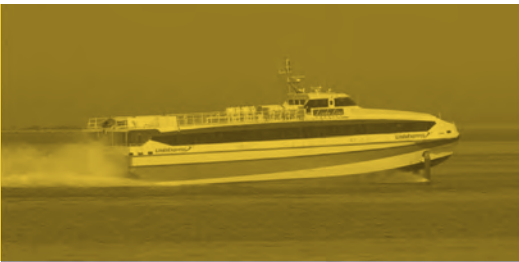
Fig. 9. El catamarán construido por Almaz Marina Yard (diseñado por la rama de San Petersburgo de la compañía británica "MTD" (Desarrollo de Tecnología Marina), es el ferry rápido de pasajeros en un patrón y la velocidad de las ganancias de unos 55 nudos (más de 100 km / hora). Ahora tendrá sólo 50 minutos en viajar desde Tallinn a Helsinki.
