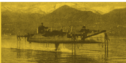
Fig. 1. La primera embarcación hidrofoil se remonta a 1906 diseñado y construido por el inventor italiano Enrico Forlanini (1948-1930). Tenía un motor de 60 caballos de fuerza motriz, la nave alcanzó una velocidad máxima de 42.5 mph.
