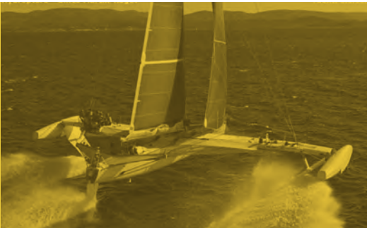
Fig. 10. Hydroptère Con una eslora de 18 metros, seis toneladas de peso y un mástil de 28 metros de altura, seis tripulantes se encargan de 'pilotar' un barco que aún no ha encontrado su techo.
